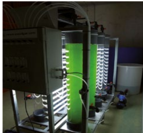
Figura 2: Elementos del sistema de crecimiento de microalgas con fotobiorreactores ubicada en edificio de ciencias de la Universidad de Vigo.
